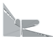
⑦ Внутренний угол собирается из двух j-профилей
